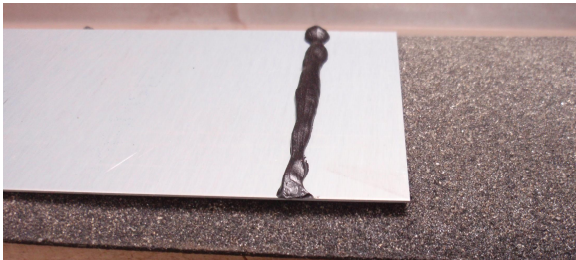
Figur 2: Eget* fugeforsegling, skal kunne være fleksibel, også når den er presset sammen mellem to plader, f.eks. bitumen-/butyl-baseret.
